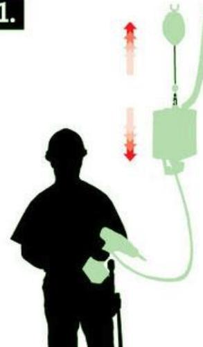
THE POSITIONER HOLDS THE APPLICATION AUTOMATICALLY AT THE DESIRED HEIGHT.
